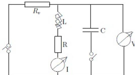
In diesem Versuch wurden die Wechselstromwiderstände von Kondensator und Spule bestimmt und daraus Induktivität und Kapazität ermittelt. Hierzu wurden Spannung und Stromstärke an Kondensator und Spule gemessen. Mit  $R = \frac{U}{I}$  ließen sich die Widerstände dann errechnen.
