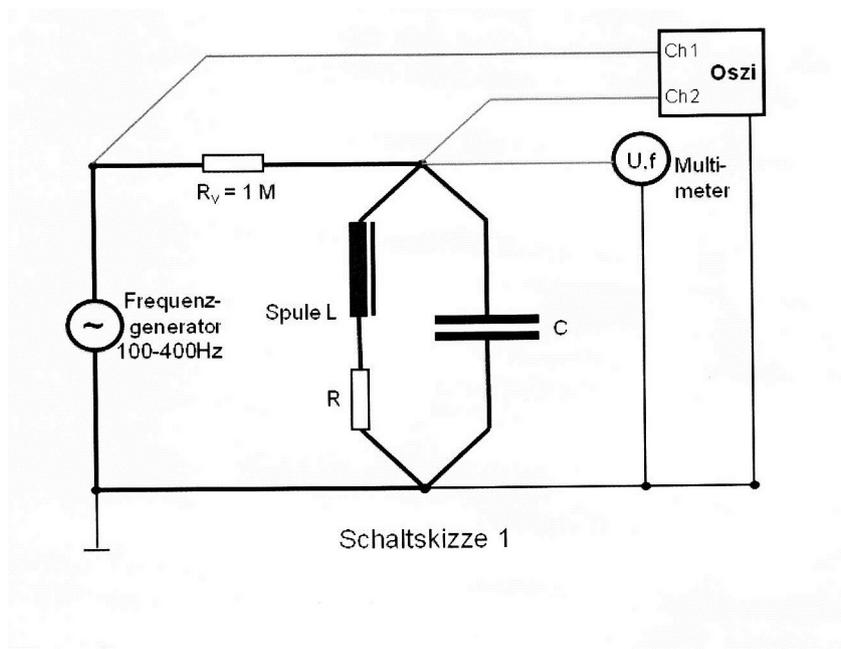
Je nach Resonanznähe variieren wir die Frequenz in  $20\text{Hz}$ - bis  $5\text{Hz}$ -Schritten. Wir messen nun (a) die Spannung am Resonanzkreis mit dem Multimeter und (b) die Phasenverschiebung ( $\Delta t$ ) mit dem Oszilloskop. Daraus errechnen wir die Phase  $\Delta\phi$ . Wir tragen  $U(f)$  und  $\Delta\phi(f)$  jeweils in einem Diagramm auf. Für die Resonanzfrequenz gilt  $\omega_0 = \frac{1}{\sqrt{LC}}$ . Daraus ergibt sich auch die Beziehung:
