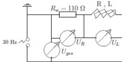
In der Schaltung nach Abb.5 sollten die Spannungen an Spule und Vorwiderstand gemessen werden. Bei einer Generatorspannung von  $U_G = 0,2V$  und einer Frequenz von  $f = 30Hz$  betrug  $U_L = 0,1558V$  und  $U_R = 0,07988V$ . Anhand dieser Werte ließen sich Verlustwiderstand  $R_L$  und Induktivität  $L$  berechnen.
