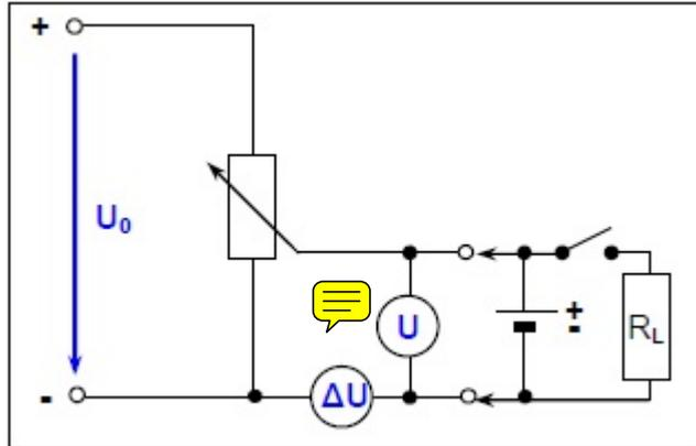
Man beobachtet nun die gleiche Kompensationsschaltung wie aus 1.6 bei verschiedenen Belastungen ( $220\Omega$ ,  $110\Omega$ ,  $47\Omega$ ,  $22\Omega$ ). Gilt wie zuvor die Beziehung  $U_H = U_0$ , so wird nun der Last-Widerstand  $R_L$  dazugeschaltet und die jeweilige Spannungs-erniedrigung  $\Delta U$  mit dem  $\mu A$ -Multizet gemessen. Es gilt:
