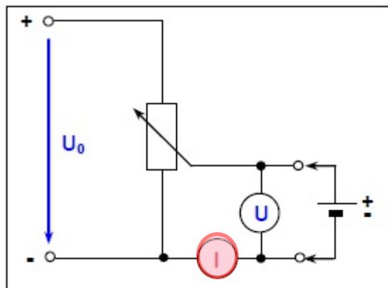
Um die Spannung an einer Trockenbatterie zu messen, war es sinnvoll eine Kompensationsschaltung zu verwenden. Hierfür sollte die Spannung der Batterie von einer
