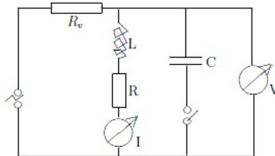
Im Folgenden werden die Wechselstromwiderstände von Kondensator und Spule bestimmt und daraus Induktivität und Kapazität ermittelt. Dafür misst man die Spannung und die Stromstärke an Spule und Kondensator. Anhand der allgemeinen Formel  $R = \frac{U}{I}$  lassen sich die Widerstände errechnen. Diese können anschließend mit den Werten  $R_C = \frac{1}{\omega \cdot C}$  und  $R_L = \omega \cdot L$  verglichen werden.
