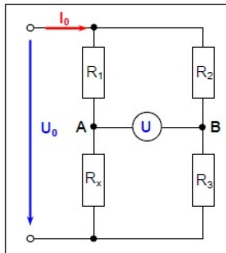
In dieser Wheatstone'schen Brückenschaltung wurde ein  $1k\Omega$ -Potentiometer einer Reihe aus unbekanntem Widerstand  $R_x$  und einem  $1k\Omega$ -Widerstand  $R$  parallel geschaltet. Ein Vorwiderstand von  $220\Omega$  diente als Strombegrenzung. Anschließend
