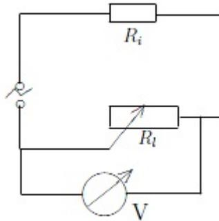
Wir regeln das Potentiometer so, dass die angezeigte Spannung gerade die Hälfte der Ausgangsspannung des Sinusgenerators beträgt. Wir lesen dann den Widerstand am Potentiometer ab, denn der Widerstand des Sinusgenerators ist gleich groß, da dieselbe Spannung über ihm abfällt. Für die Leistung gilt:
