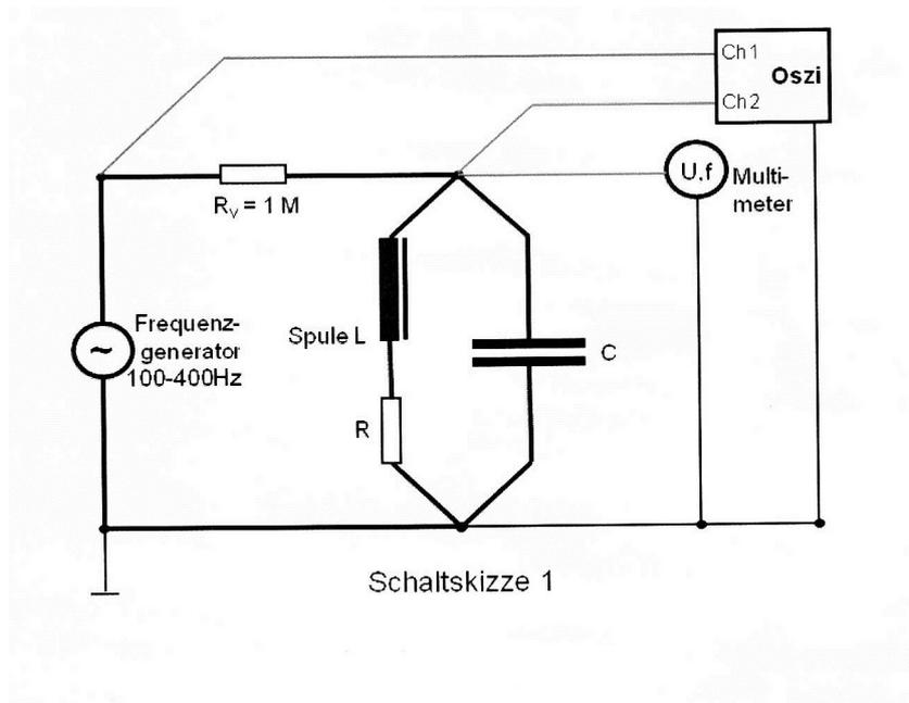
Nach Abb.6 wurde eine Schaltung aufgebaut und anschließend ihr Resonanzverhalten untersucht. Die größtmögliche Generatorspannung, die wir einstellen konnten, betrug  $U_G = 0,196V$  und die dazugehörige Resonanzfrequenz war nach Anzeige
