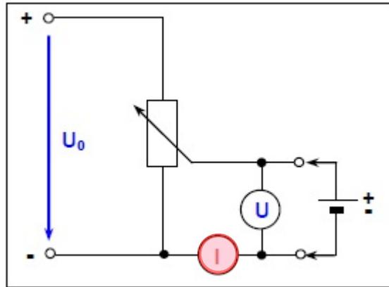
Wir regeln nun mit Hilfe des Potentiometers die Differenzspannung auf 0, sodass kein Strom mehr fließt. Die Ursprungung der Trockenbatterie ist so direkt am Spannungsmessgerät ablesbar.
