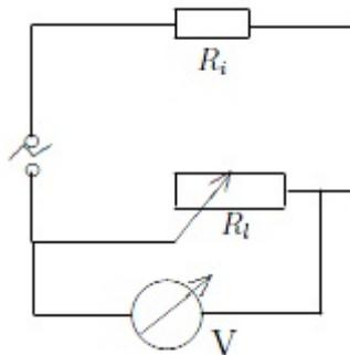
Hierzu wird ein  $1k\Omega$ -Potentiometer genau so eingestellt, dass an ihm eine halbe Leerlaufspannung  $\frac{U_0}{2}$  anliegt. Wenn dies der Fall ist, so ist der Innenwiderstand des Generators gleich dem Widerstand des eingestellten Potentiometers. Schließlich soll man die maximale Ausgangsleistung ermitteln:
