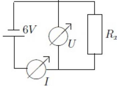
Der Wert eines unbekanntes Widerstandes  $R_x$  sollte bestimmt werden. Hierzu wurde er mit einem Widerstand  $R = 10k\Omega$  und einem Strommessgerät in Reihe an eine Spannungsquelle  $U = 6V$  geschlossen. Anschließend sollte die Spannung einmal spannungsrichtig, das andere Mal stromrichtig gemessen werden. Diese Messung wurde noch einmal mit vertauschten Messgeräten durchgeführt:
