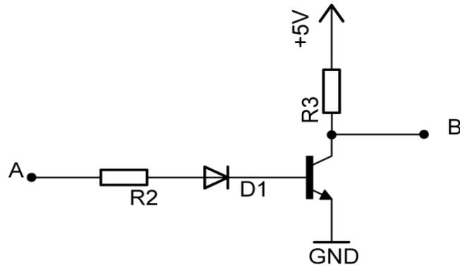
Diese Schaltung soll das Eingangssignal umkehren. Liegt an A **1** an, fließt ein Basis-Emitter-Strom, durch den der Transistor aktiviert wird. Da der Transistorwiderstand sehr gering ist, fällt der Großteil der Spannung an R3 ab und somit hat B das niedrige Potential **0**. Ist jedoch A **0** dann fließt kein Strom mehr und der Transistor sperrt. Der Widerstand des Transistors ist nun so hoch, dass fast die gesamte Spannung nun an ihm abfällt. B hat nun das Potential **1**.
