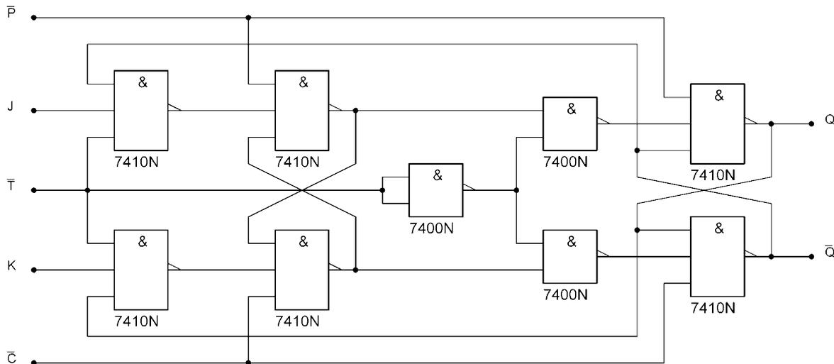
Liegt an am Takteingang 0 an, so wird dieses Signal negiert und der erste RST-FF („Master“) ist enabled. Jetzt kann hier in diesem Moment über den Set Eingang J (hier: „Jump“) eine Information in  $Q_{Master}$  gesetzt werden oder über den Eingang K („Kill“) „gelöscht“ werden ( $\bar{Q}_{Master} = 1$ )
