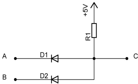
Dioden lassen den Strom nur in eine Durchflussrichtung hindurch. Diese zeigt die „Pfeilform“ an.
