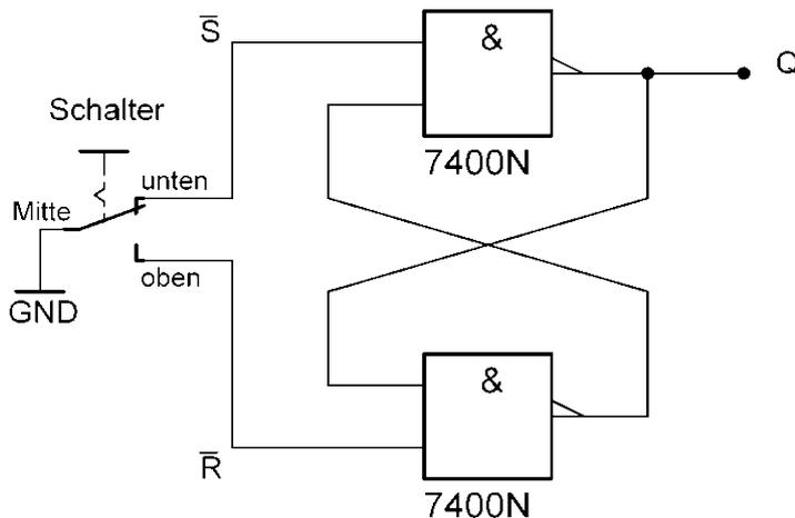
Man nutzt aus, dass ein offener Eingang automatisch auf 1 steht. R ist in diesem Fall also immer 1. Wird oben nun die Verbindung hergestellt, kommt es dazu das bei S 0 anliegt und die 1 in Q gespeichert wird. Prellt der Schalter kann an S kurzzeitig 1 anliegen, was den Speicherstand aber nicht verändert. Dafür müsste der Schalter schon in die entgegengesetzte Richtung gesetzt werden. Das Problem des Prellens wurde behoben.
