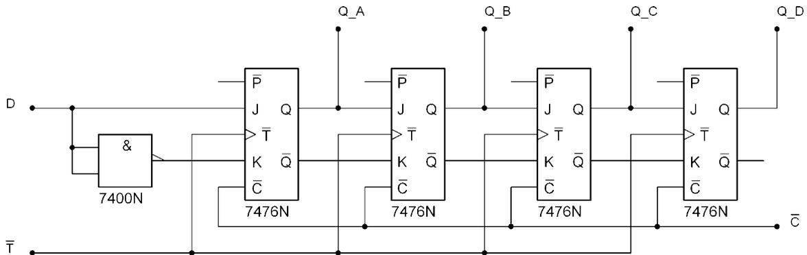
Das Schieberegister kann zudem zum multiplizieren und dividieren genutzt werden. Durch das Weiterschieben einer Stelle multipliziert oder dividiert man die Zahl mit 2.
