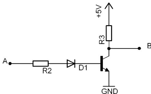
Liegt am Eingang 1 so fließt ein Basis-Emitter Strom. Zudem fließt ein Strom durch den Collector. Somit ist der Transistor offen und der Strom fließt durch den Widerstand R3, durch den Transistor in die Erde. Somit liegt an B keine Spannung an: 0
