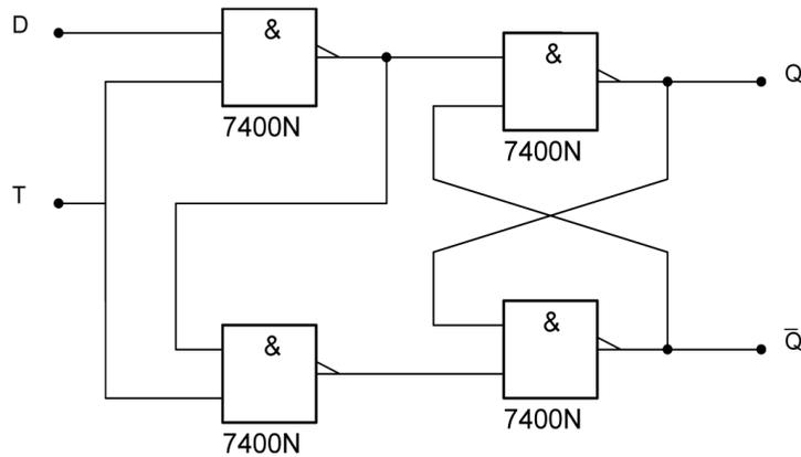
RST-FF und D-FF sind taktzustandgesteuerte Flip-Flops. Das besagt, dass der Zustand von Q und  $\bar{Q}$  verändert werden kann, solange  $T = 1$  ist.
