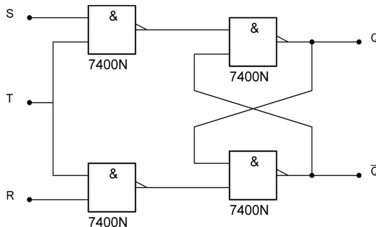
In der Aufgabenstellung wird nach einer Lösung gefragt, wie der verbotene Zustand des RST-FF eliminiert werden kann. Das kann dadurch gewährleistet werden, indem man den Reset Eingang R per Negation an den Set Eingang anschließt. Ersetzt man also R mit dem Ausgang des NAND Gatters von S und T, gilt  $R = S$  (man beachte, dass dies dann umgesetzt wird, wenn  $T = 1$  gilt). Es wurde also der verbotene Zustand eliminiert.
