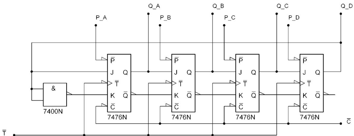
Der Unterschied liegt darin, dass die Information hier parallel über die Preset Eingänge eingegeben werden und dass der letzte Ausgang wieder am Eingang des ersten JK-MS-FF anliegt. So wird die Information dauerhaft durch die Anordnung gegeben. (Bsp: Laufschriften)
