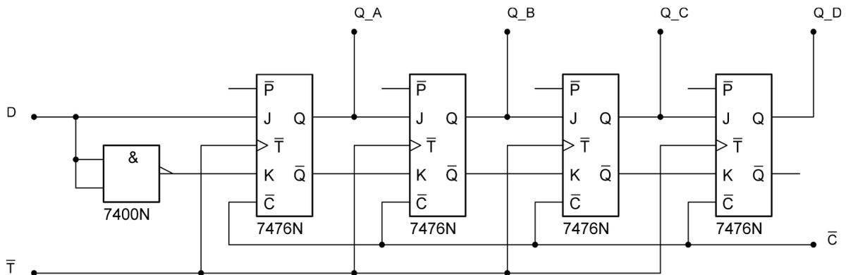
Das 4-Bit-Schieberegister entspricht einem Seriell-Parallel Wandler. Hierzu werden 4 JK-MS-FFs hintereinander geschaltet, wobei die Eingänge J/K an die Ausgänge Q/Q des vorangehenden JK-MS-FFs angeschlossen sind. Wenn man nur über einen Eingang ein Signal eingeben möchte, kann man wie beim D-FF den Killeingang des ersten JK-MS-Flip-Flops über einen Inverter an den Jumpeingang anschließen. Es werden dann nur die Daten von Ersatzeingang D weitergegeben.
