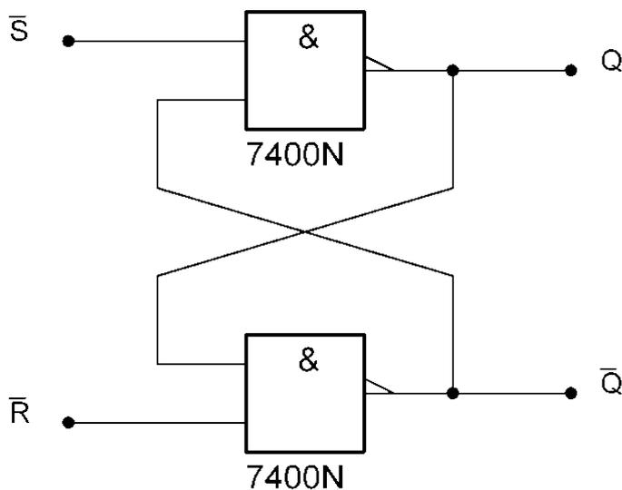
Man sieht, dass der Ausgang eines NAND-Gatters am Eingang des anderen NAND-Gatters angeschlossen ist. Das heißt, dass jeder Eingang von dem Ergebnis des anderen Eingangs abhängig ist. Die Eingänge des RS-Flip-Flop werden negiert, um die Gegenüberstellung mit dem RST-Flip-Flop anschaulich zu machen.
