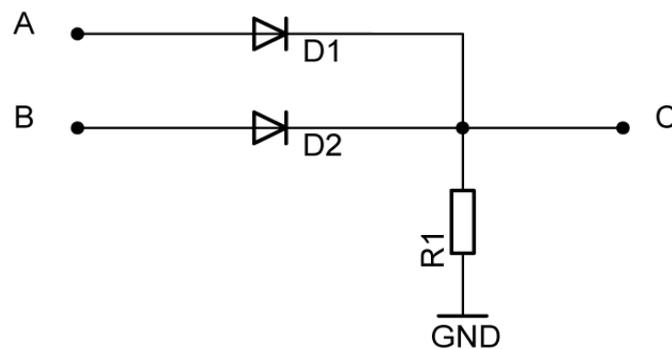
Der Ausgang dieser Schaltung hat das Potential **1**, sobald einer der Eingänge auf 1 steht. Der Widerstand R1 ist viel größer als der Widerstand der beiden Dioden, so dass der Großteil der Spannung an ihm abfällt und C das Potential **1** hat. Liegt jedoch sowohl an A als auch an B **0** an, fließt kein Strom und C hat das Potential **0**.
