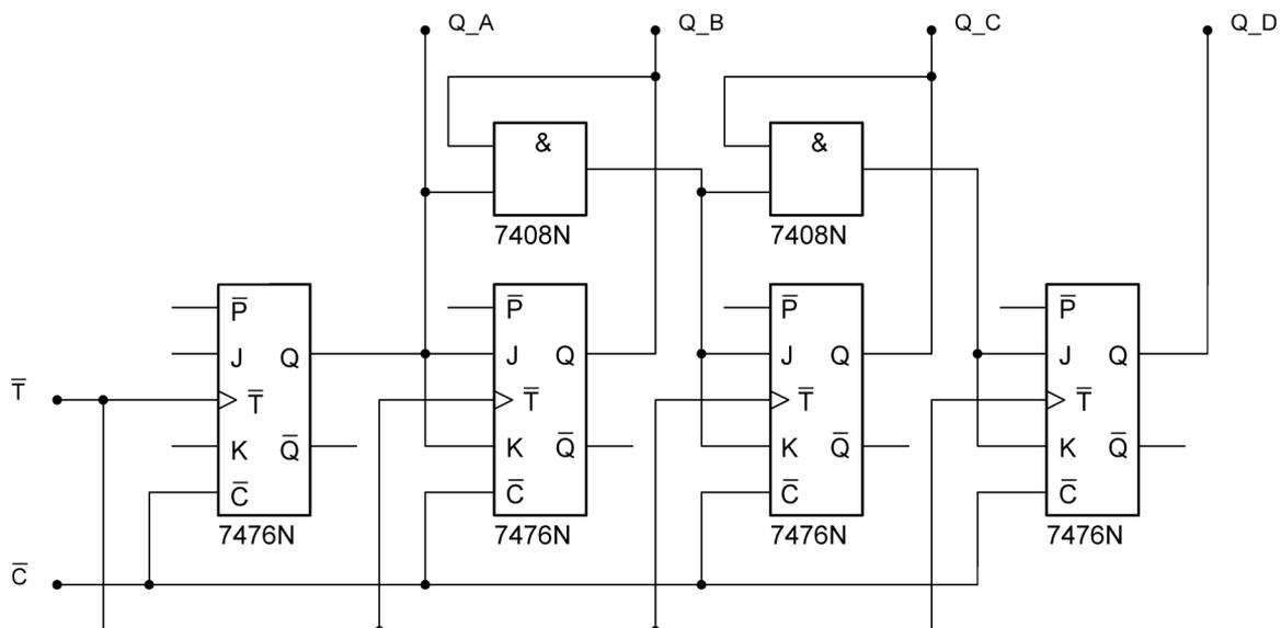
Um den Schaltung simpel wie möglich zu halten, kann an ein AND-Gatter an das nachfolgende angeschlossen werden. Der Nachteil der hintereinander geschalteten Gatter liegt darin, dass durch die Zeitverzögerung, bedingt durch die einzelnen Schaltungen, es zu Fehlern kommen kann.
