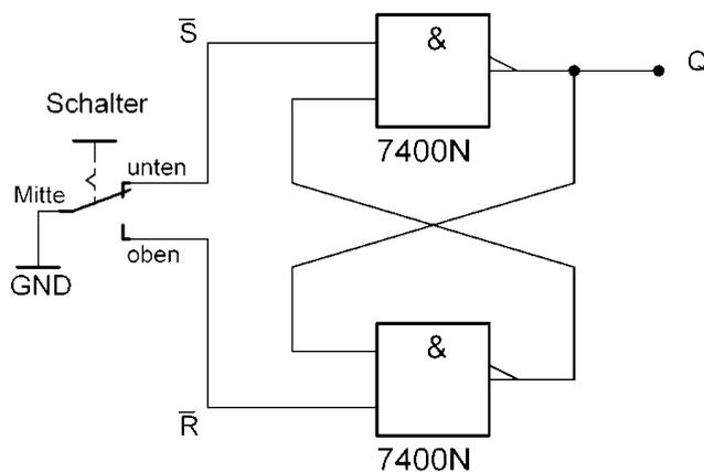
Hier machen wir es uns zu Nutze, dass nicht angeschlossene Eingänge auf 1 liegen. Prellt nun ein Schalter an einem Kontakt ab, so verliert er kurzzeitig den Kontakt, dennoch ändert das nichts am Ausgang, denn um den Eingang zu invertieren, muss ein Kontakt zum anderen Eingang entstehen. Beim prellen geschieht nichts, denn hier bleibt der Ausgangszustand einfach erhalten.
