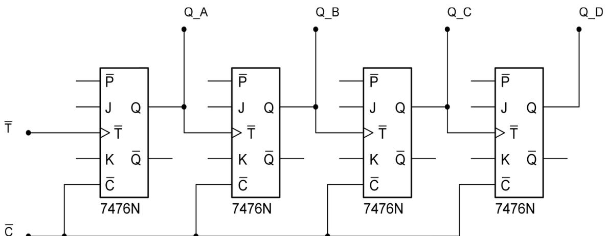
Der 4-Bit-Asynchrözähler besteht aus vier hintereinandergeschalteten JK-MS-FFs, wobei der Takteingang eines FFs an den Ausgang Q des vorangehenden FFs angeschlossen sind.
