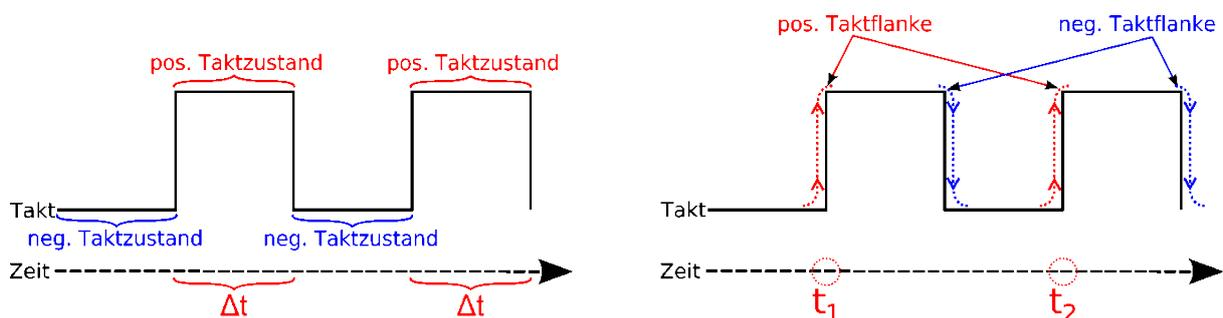
Das erste Bild beschreibt ein Taktzustandsgesteuertes Flip-Flop. Hier kann man erkennen, dass der Zustand 1 über einen Zeitraum  $\Delta t$  vorhanden ist. Während dieses Zeitraumes können die Zustände der Eingänge immer verändert werden. Der Ausgang passt sich in diesem Zeitraum den Eingängen immer an. Am Ende bleibt der Zustand, des letzten eingestellten Zustands erhalten.
