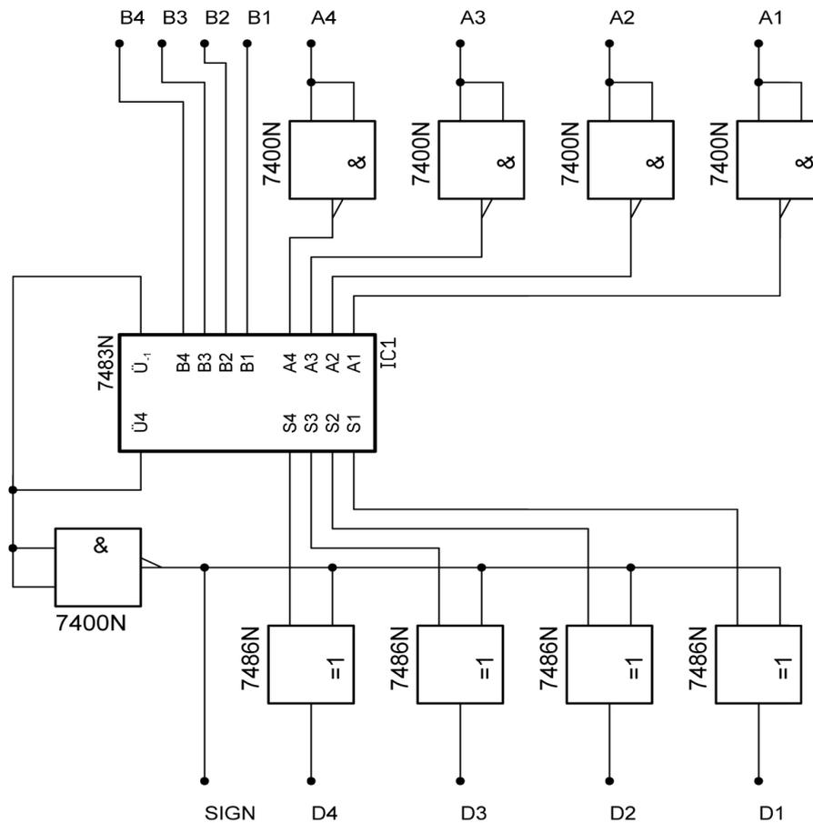
Wie man erkennen kann, werden die einzelnen Bits der Zahl  $A_4A_3A_2A_1$  durch gleichgeschaltete NAND Gatter negiert. Das entspricht folgendem:
