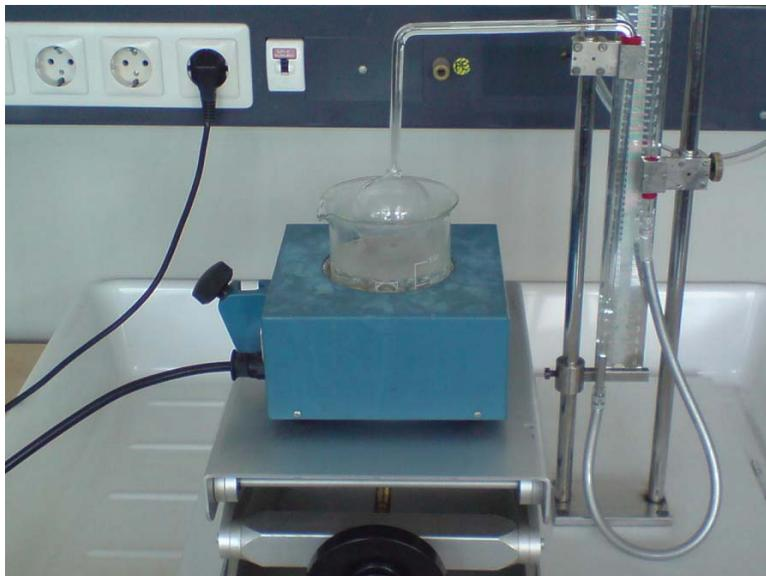
Abbildung 2: Jollysches Gasthermometer
