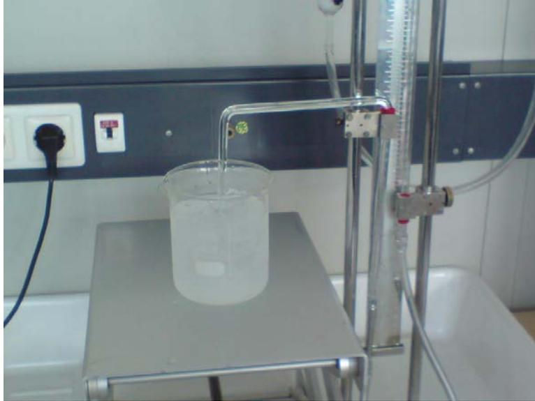
Abbildung 1: Jollysches Gasthermometer
