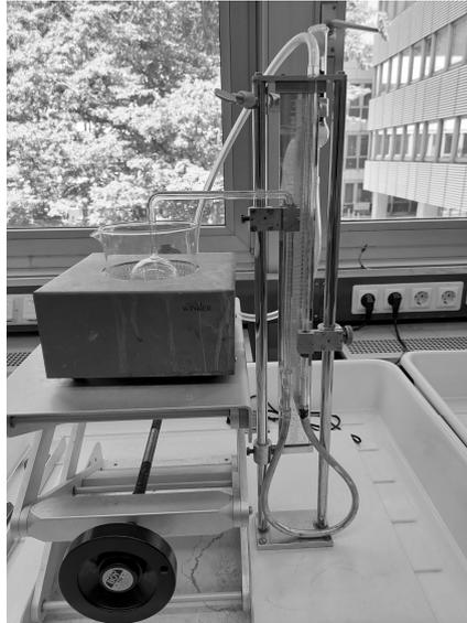
Abbildung 3.1.: A1 - Foto des Jollyschen Gasthermometer
