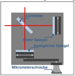
Dunkel-Durchgänge, durchlaufen haben. Die hierzu nötige Verschiebung des Spiegels notieren wir uns, wobei darauf zu achten ist, dass die Mikrometerschraube mit einer Übersetzung um den Faktor 10 ausgerüstet ist. Der tatsächliche Wert ist somit um den Faktor 10 kleiner als der an der Skala abgelesene Wert.
