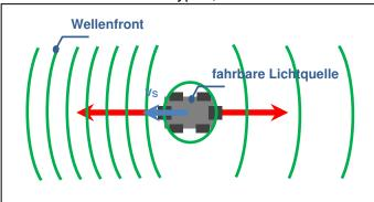
Grundlegend beschreibt der Dopplereffekt die geschwindigkeitsabhängige Wahrnehmung und Messung von Frequenzen für bewegte Sender und/oder Empfänger. Bewegt sich der Sender mit einer Geschwindigkeit vs auf den ruhenden Empfänger zu, so erhöht sich die gemessenen Frequenz als Ursache der Überlagerungen von Ausbreitungsgeschwindigkeit der Welle sowie der Geschwindigkeit des
