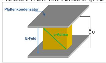
der Inversionssymmetrie aufweisen (vgl. nichtlineare Optik) in das elektrische Feld eines Plattenkondensators ein, so gehen optisch isotrope Medien über in die Doppelbrechung. In Folge dessen bildet sich im Kristall eine kristallografische Achse aus, die c-Achse genannt wird, entlang derer sich eine elektromagnetische Welle schneller ausbreitet als eine hierzu senkrecht verlaufende Welle. Diesen Effekt bezeichnet man als den optischen Kerr-
