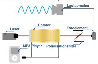
dient uns hier ein Bleisilikatglasstab, dessen Eigenschaft das einfallende linear polarisierte Licht des Lasers zu drehen über eine Magnetfeldspule beeinflusst wird. Die Variation der magnetischen Flussdichte B erfolgt über die Speisung aus einem Zweilautsprecher-Ausgang eines MP3-Players. Nach Passieren des Rotators erfolgt die eigentliche Modulation, d.h. die Abwandlung der Intensitätsamplitude, über einen Polarisationsfilter. Diese
