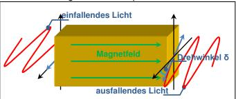
schen Körper (Faraday-Rotator) propagiert. Das äußere Magnetfeld H mit der magnetischen Flussdichte B verläuft hierbei stets parallel zur Ausbreitungsrichtung der einfallenden Lichtwellen.
