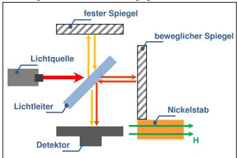
Wird ein ferromagnetisches Material wie Eisen, Kobalt oder Nickel durch ein äußeres Magnetfeld H angeregt, so richten sich im Material gewisse Bereich, die sogenannten Weiß'schen Bezirke, je nach Stärke des äußeren Magnetfeldes entlang dessen magnetischer Feldrichtung aus. Die damit verbundene Neuordnung führt gleichermaßen zu einer minimalen Längenzunahme des verwendeten Materials. Bringen wir solch einen ferromagnetischen Stoff nun an einen der Spiegel an und magnetisieren den Körper
