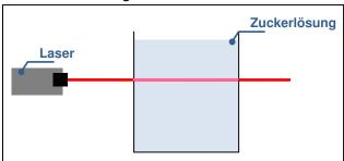
ration k als auch für die Variation des Laufweges d experimentell bewiesen werden. Da uns lediglich ein Gefäß für das Experiment zur Verfügung steht, kann die Wegabhängigkeit nur für zwei unterschiedliche Laufwege demonstriert werden.
