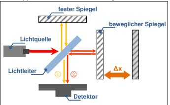
zentriert. Diente es ursprünglich im Michelson-Morley-Experiment dazu, die Ausbreitung von Licht in verschiedenen Medien zu untersuchen, kommt es heute vorrangig in der Messung kleinster Abstände (im Bereich der Wellenlänge des verwendeten Lichtes) sowie in der Astronomie zur Verbesserung der Auflösung von Radioteleskopen zum Einsatz.
