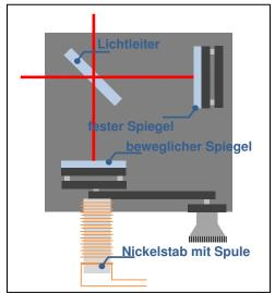
genabhängigkeit näher untersuchen. Hierzu wird der bewegliche Spiegel mit einem Nickelstab verbunden, der anschließend durch ein äußeres Magnetfeld H angeregt und sich damit erwartungsgemäß um einen gewissen Faktor ΔI verschieben müsste.
