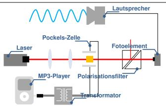
Rotator durch die Pockels-Zelle mit Lithiumniobat-Kristall. Um den Laserstrahl möglichst konzentriert auf den Kristall zu lenken versehen wir das System mit zwei zusätzlichen Linsen zwischen Laseraustrittsöffnung und Pockels-Zelle. Die dem Laser zugewandte Linse führt dabei zur Divergenz, d.h. zur Aufweitung des Laserstrahls, die zweite Linse demzufolge wieder zur Konvergenz, d.h. zur Konzentrierung des Laserstrahls auf den Kristall. Das unter 45° zur Polarisati-
