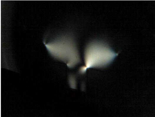
Als erstes spannten wird das pyramidenförmige Modell ein. Hier konnte man gut erkennen, dass sich besonders an den Ecken Spannungszentren ausbilden, die an dem Treffpunkt der zwei Kanten besonders stark sind und sich fast über das ganze Modell ausbreiten. Der obere Bereich bleibt jedoch komplett dunkel, was zeigt, dass sich der Druck dort am besten verteilt.
