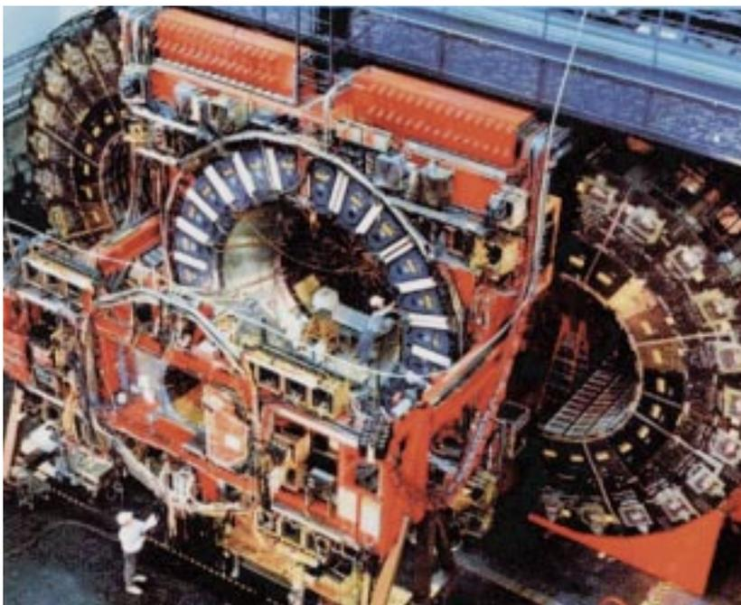
**Abb. 1: Photographie des CDF-Detektors in der Wartungshalle. Die zylindrische Öffnung gewährt Einblick auf die zylinderförmige Spurenkammer, in deren Zentrum während der Datennahme die Strahlen gegeneinanderprallen. Dem Aufbau einer Zwiebel gleich umhüllen weitere Detektorlagen den Zentralbereich, um alle Arten von bei einer Kollision erzeugten Teilchen registrieren zu können. Während des Messbetriebes umschließt der Detektor den Kollisionsort der Strahlen fast vollständig.**
