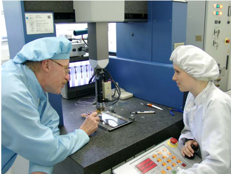
Abb. 12: Siliziumstreifendetektor bei der optischen Inspektion mit einer Zeiss-Meßmaschine am IEKP. Sämtliche Labors des IEKP befinden sich übrigens am Forschungszentrum Karlsruhe, einige Geräte wie diese Koordinatenmeßmaschine wurden dem Institut freundlicherweise übertragen.
