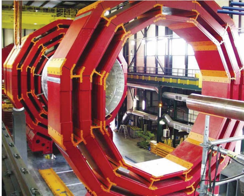
Abbildung 11: Foto des Eisenjochs des CMS-Magneten vor Einbau der inneren Detektoren. Der Magnet hat eine Höhe von 15m und Länge von 22m.
