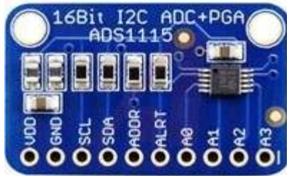
Betriebsspannung 2,0 V – 5,5 V
