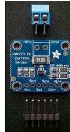
Strom- u. Spannungssensor
