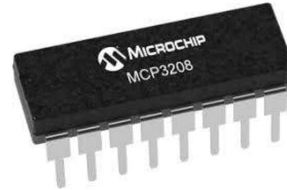
Betriebsspannung 2,7 V – 5,5 V
