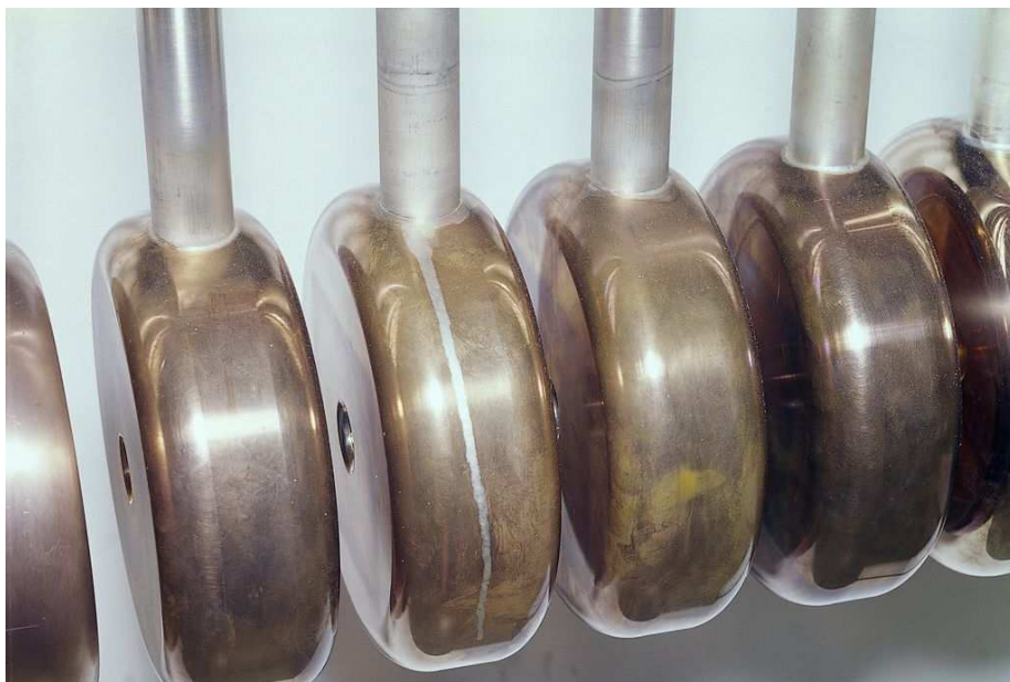
Driftröhren des LINAC2
