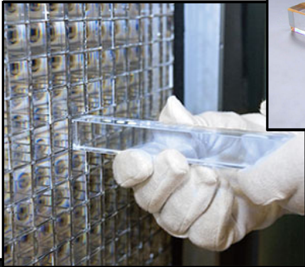
Bleiwolframat Einkristalle des CMS ECAL
