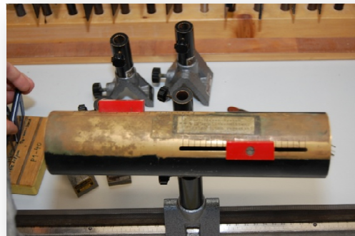
Abbésches Verfahren: Versuchsaufbau (links), Zweilinsensystem im Tubus (rechts)
