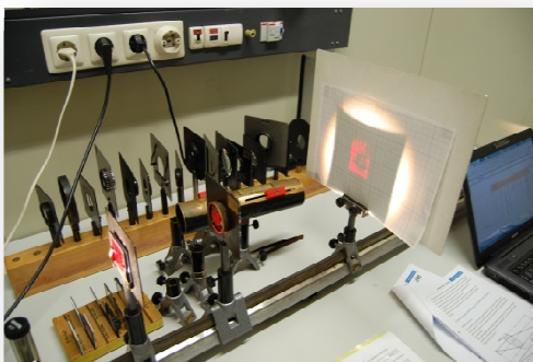
Besselsches Verfahren: Versuchsaufbau „rot achsenfern“
