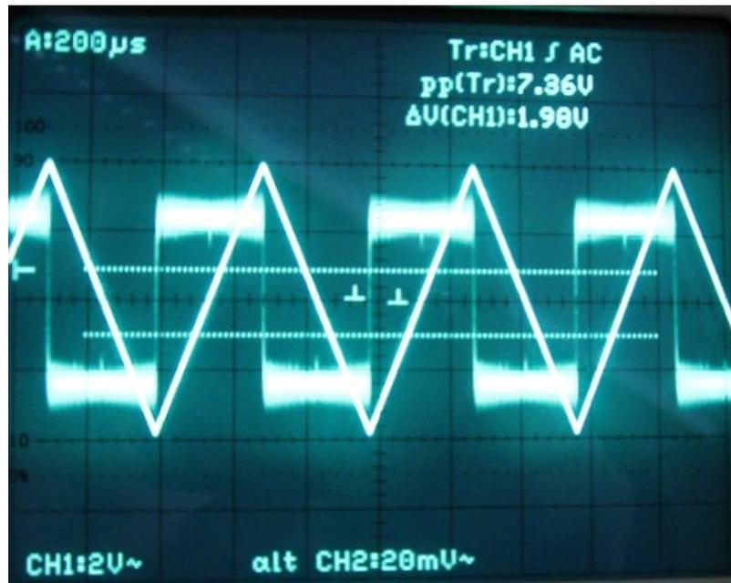
Das Ausgangssignal ist zwar schwach, aber die Rechtecksform ist gut ausgebildet und erkennbar. Die Vorzeichenwechsel in der Ausgangsspannung sind zur gleichen Zeit wie der Steigungswechsel bei der Eingangsspannung
