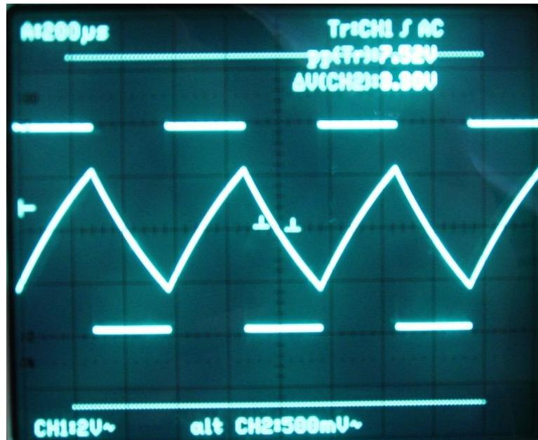
Die Dreieckspannung ist gut erkennbar und abgesehen von leichten Wölbungen fast perfekt. Die Vorzeichenwechsel in der Steigung passen genau mit der Spannungsumkehrung überein.
