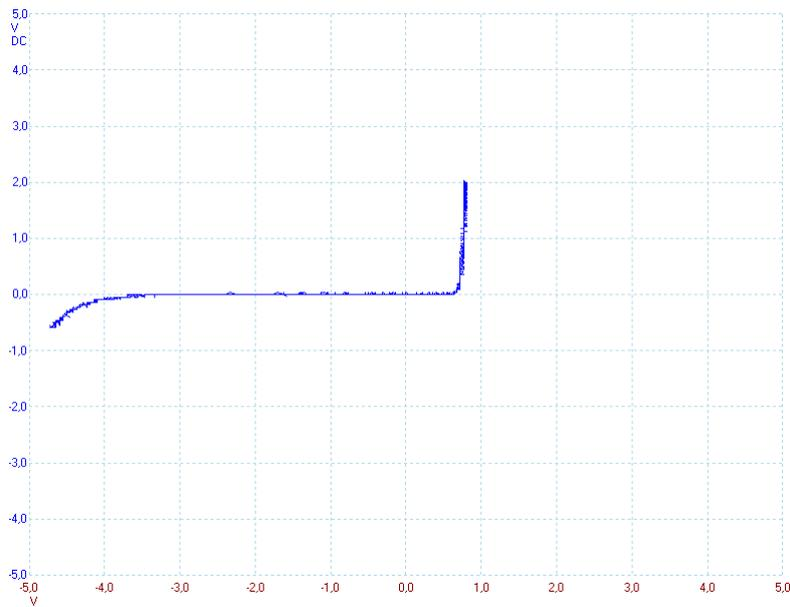
Die Schwellenspannung betrug in Durchlassrichtung 745,0 mV, die Durchbruchspannung konnten wir ebenfalls an diesem Schaubild ablesen, sie betrug -4,264 V. Eine Zener-Diode wird meist in Sperrichtung betrieben.
