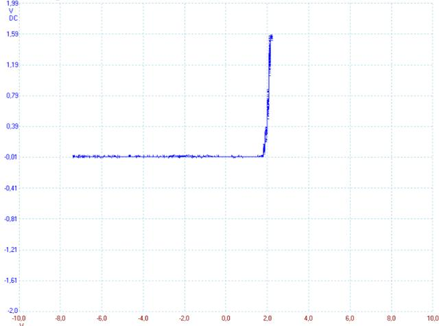
Die Durchlassspannung betrug 1,981 V.
