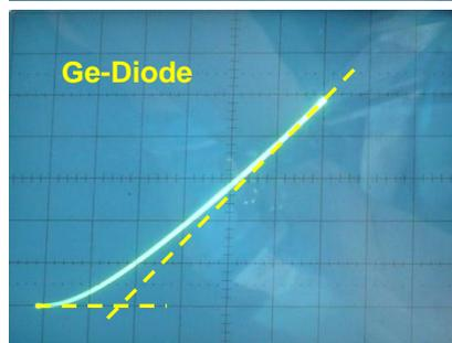
Bei einer x-Achsenkala von 0.1V/SKE erhalten wir für die Siliziumdiode so einen Wert von genau 0.7V, was dem typischen Wert einer Siliziumdiode entspricht. Für die Germaniumdiode erhalten wir bei gleicher x-Achsenkala einen Wert von knapp unter 0.2V, was etwas außerhalb des erwarteten Intervalls 0.2V...0.4V liegt.
