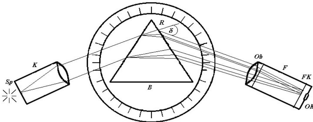
Nach Brechung an den beiden Prismenflächen tritt das Licht - jede Wellenlänge unter anderem Winkel, aber jede Wellenlänge als Parallelbündel - in das drehbare Fernrohr  $F$  ein. Das Objektiv  $Ob$  vereinigt jedes Parallelbündel zu einer Spektrallinie (farbiges Spaltbild).
