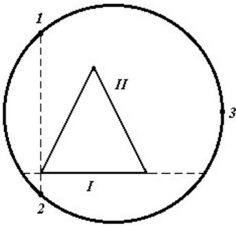
Zu b): Sie stellen die sich in  $R$  treffenden Prismenflächen  $I$  und  $II$  senkrecht zur  $F$ -Achse, indem Sie nach nebenstehender Abbildung, zuerst Fläche  $I$  mittels der Stellschrauben 1 und 2 des Prismentischchens justieren, dann Fläche  $II$  mit Schraube 3.
